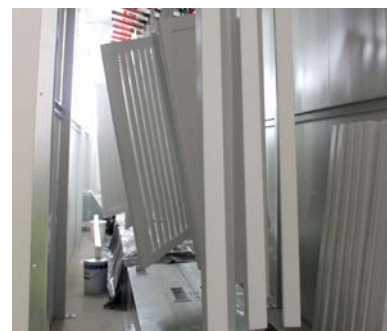
Painted products in drying chamber • Lackierte Produkte in der Trockenkammer • Les produits peints transitent par une chambre de séchage • Productos pintados en la cámara de secado • Prodotti verniciati in camera di essiccazione
