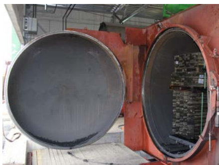
Pressure-treated wooden details in a wood treatment autoclave • Autoklav-Anlage für kesseldruckimprägniertes Holz • Détails en bois traitées en autoclave dans une station d'imprégnation • Detalles de madera tratada en autoclave en un recipiente a presión • Dettaglio del trattamento in autoclave
